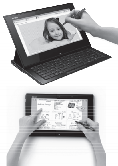
タブレット型・キーボード型がすばやく切り替えられるサーフスライダー方式が筐体上の大きな特徴。なお、開いている状態でもタッチペンは同じように利用可能
