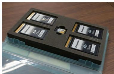
1時間の番組がエクスプレスP2カード4枚とマイクロP2カード1枚の計5枚でセットされる
