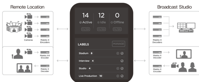
【図 1】新ソリューション① 「Haivision Encoder/Decoder」などをクラウドから集中管理するマネジメントのイメージ
