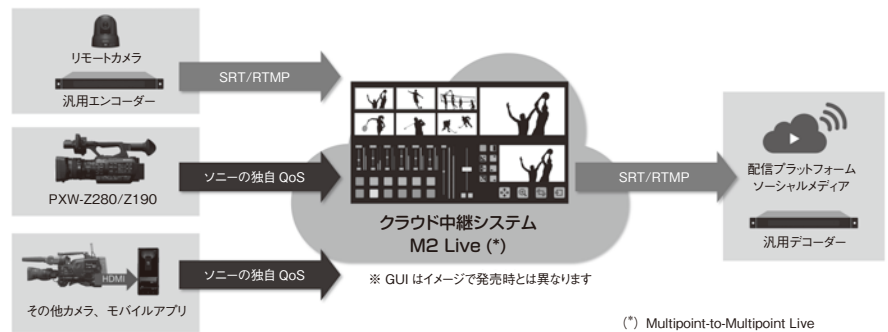
【図】ソニー「クラウド中継システム M2 Live」の概要
