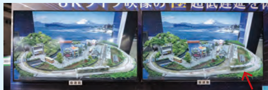
実験的に伝送システムを遅延 500ms にしたデモ。左は伝送前の 8K 映像、右は「ELL 8K」でエンコード/デコードした伝送後の 8K 映像で、鉄道模型を時計回りに走らせて撮影した。右の伝送後の 8K 映像の電車の位置は、左の伝送前の 8K 映像より遅延時間の分だけ大きく遅れている
