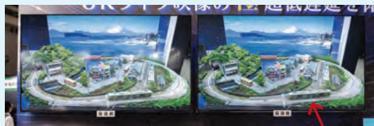
遅延時間を短縮した新しい伝送システムのデモ。右の伝送後の 8K 映像の電車の位置は、左の伝送前の 8K 映像とほとんど変わらず、遅延時間の短さを示している
