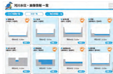
「水DX」の水位情報。各河川の断面図にイラストやアニメーションで水位を視覚化している
